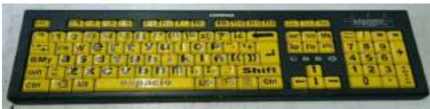
Primera versión del teclado con caracteres macrotipo como apoyo para alumnos con debilidad visual.
